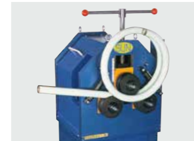
丸パイプ曲げ
